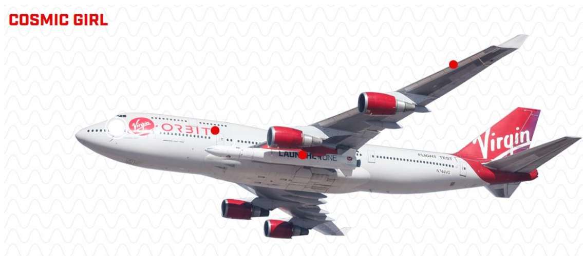
Fig. 4 – Boeing 747-41R N744VG Cosmic Girl com foguete LauncherOne sob a asa, aproveitando as capacidades estruturais para o transporte de um quinto reator, não-funcional. A configuração apresentada não é substancialmente diferente daquela dos bombardeiros B-52 municiados com mísseis balísticos, solução prototipada há mais de 50 anos, mas sem entrada em serviço.
